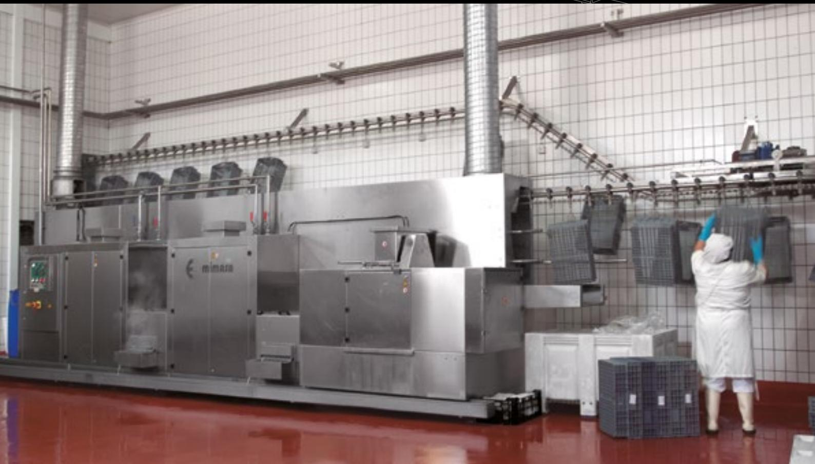
Los túneles de lavado de cajas, bandejas y envases también pueden adaptarse al sistema de transporte aéreo de la instalación del cliente o incorporar su propio transportador aéreo.
